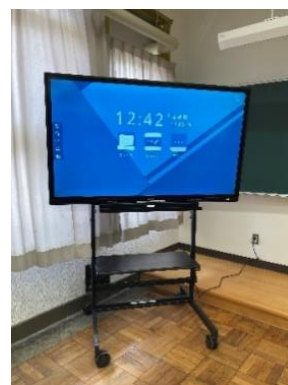
各教室に設置された モニター型電子黒板
